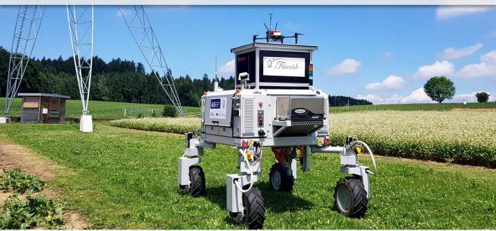
L'UGV funge da **piattaforma mobile di atterraggio e di ricarica** per l'UAV· Durante le missioni, l'UAV atterra sull'UGV e decolla da esso in autonomia per ricaricare la sua batteria e per caricare i dati sul **modulo di analisi dati** dell'UGV·
